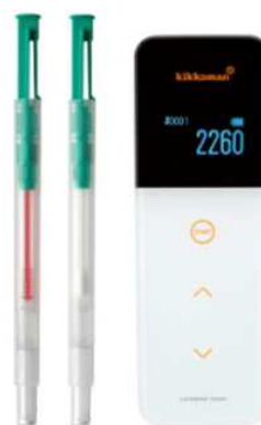
ルミテスター-smart(キッコマン) ATP+ADP+AMPふき取り検査(A3法)
